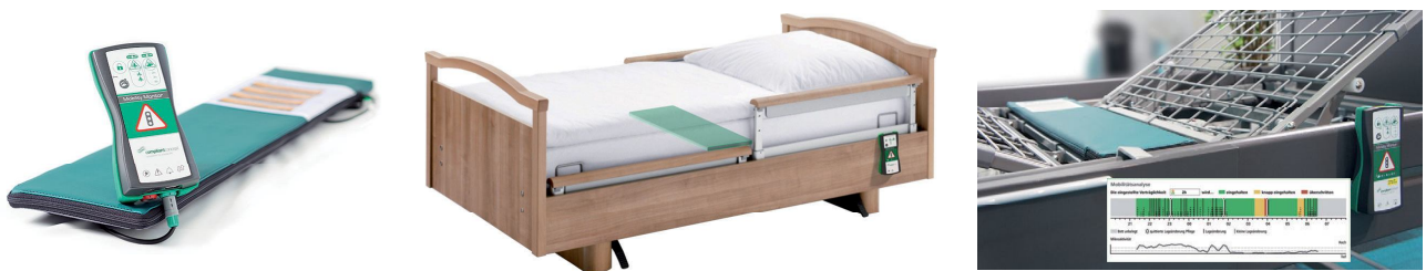
Abb. 9.1-5 (a-c) Beispiel für ein Gerät zur Prüfung und Überwachung von Eigenbewegungen. Durch einen Sensor unter der Matratze werden Eigenbewegungen des Pflegebedürftigen automatisch erfasst und dokumentiert. Bei Bedarf kann bei ausbleibenden Bewegungen ein optisches Warnsignal ausgelöst werden.
